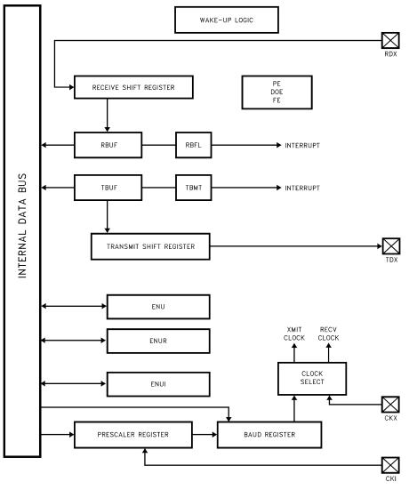
Figure 30. USART Block Diagram
